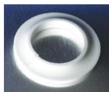
Anel absorvente de choque em polietileno desenvolvido para reduzir quebra de provetas. Para obter os melhores resultados, deslize o anel para o topo para absorver choques, caso a proveta caia acidentalmente.
