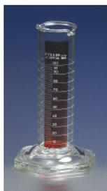
Calibrada “para conter”. A escala e os números estão em esmalte branco resistente, que se destacam claramente contra a faixa vermelha das provetas Lifetime Red. A proveta é do tipo Tuttle de formato baixo para estabilidade e apresenta um duplo escoamento para maior comodidade.
