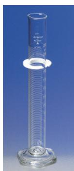
Calibrada “para entregar” em conformidade com as especificações ASTM E-1272 e ASTM E-542. Cada proveta é serializada individualmente e fornecida com um Certificado de identificação e capacidade, controlável pelos padrões NIST. Graduações permanentes na cor branca são fáceis de ler. Pára-choques protetores são fornecidos nos tamanhos de 25 mL até 2000 mL. O tamanho 10 mL tem boca de funil.
