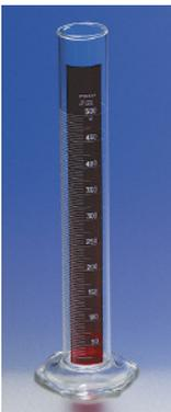
Calibrada “para conter”. A escala e os números estão em esmalte branco resistente, que se destacam claramente contra a faixa vermelha das provetas Lifetime Red. O tamanho 10 mL tem boca em funil. Pára-choques protetores são fornecidos nos tamanhos de 100 mL até 2000 mL. O tamanho 100 mL foi fabricado em conformidade com as especificações ASTM E-133 e E-1272 e é usado em testes ASTM D-86 e D-216.
