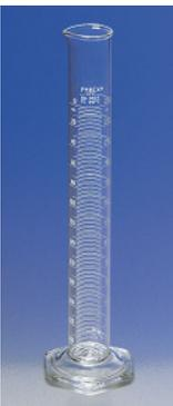
As provetas são calibradas “para entregar” em conformidade com as especificações ASTM E-1272 e ASTM E-542. A escala dupla, com numeração ascendente e descendente, está em esmalte azul resistente. Fornecida com pára-choques protetores de polietileno.
