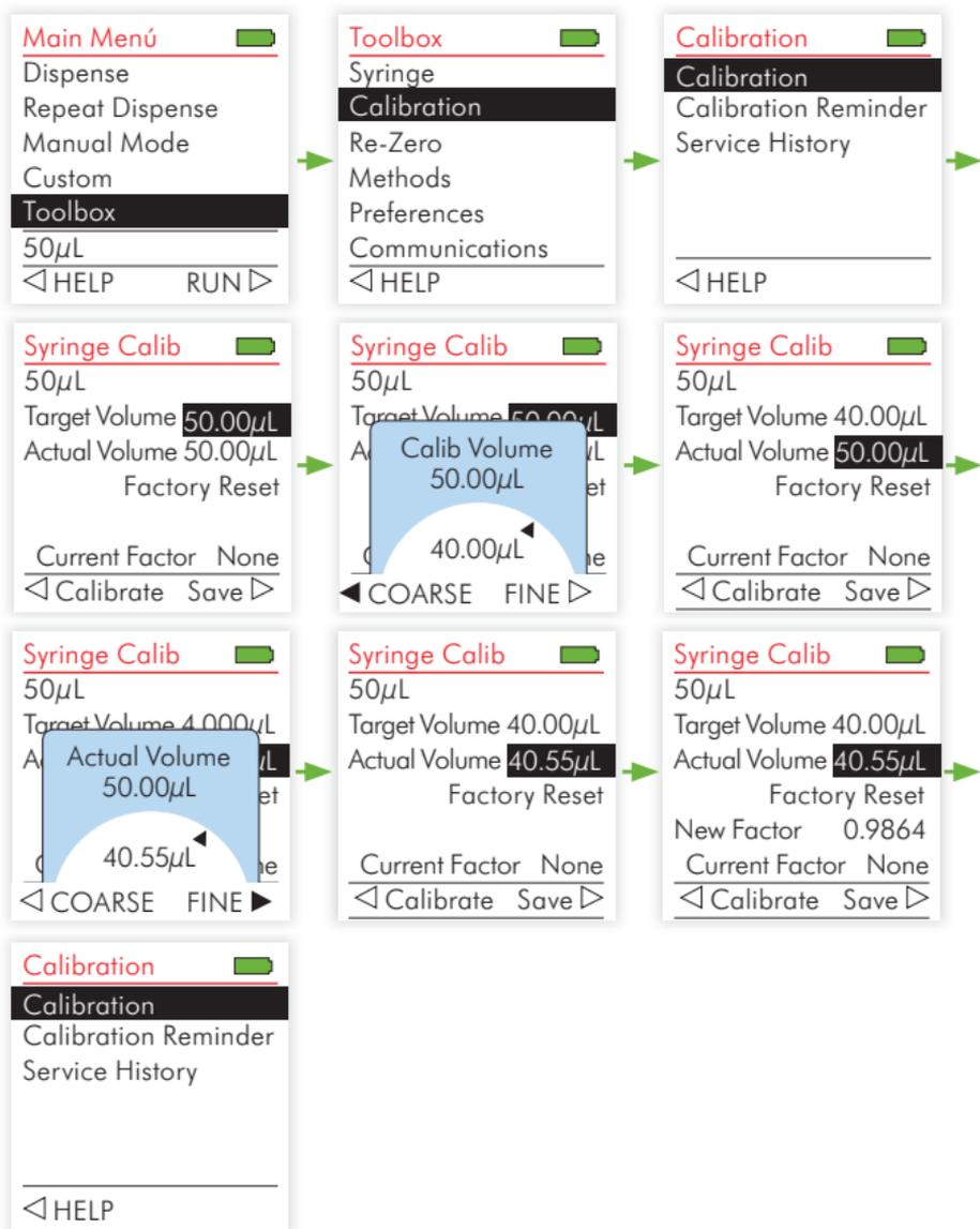
Figura 15. Como ingresar la Información de Calibración al Instrumento.
