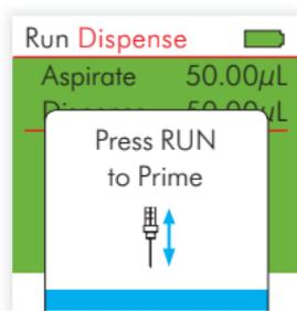
En algunos casos, la secuencia de apresto no irá a remover todas las burbujas de aire de la jeringa. Esto se debe al límite de velocidad máxima que el pistón de velocidad obtiene. En este caso, desconecte la jeringa y siga el procedimiento manualmente.
